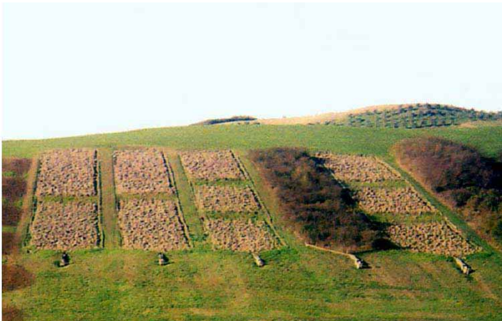
Figura 12. Impianto parcelle a Vicarello (Volterra) per la misura dei deflussi e dell'erosione; si notino le strisce inerbite.
